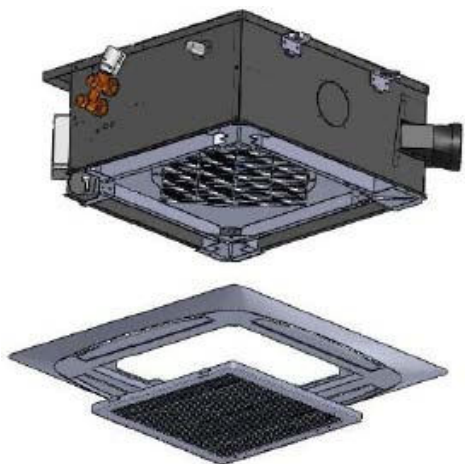
Obrázek 42 Krok 3: Vyměňte přední panel a odpojte víceotáčkový motor a IR přijímač.
