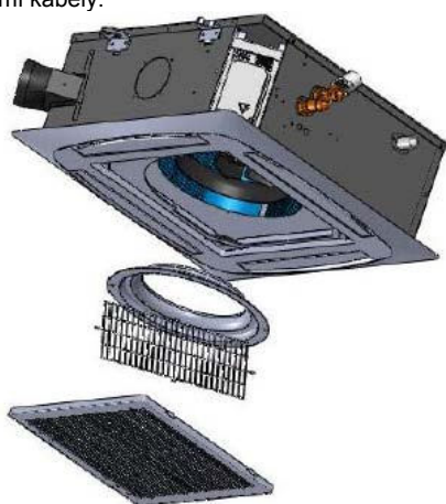
Obrázek 34 Krok 1: Po vyjmutí mřížky získáte přístup k oblasti se spojovacími kabely.
