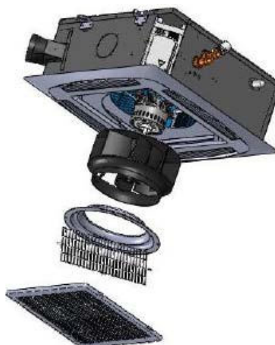
Obrázek 41 Krok 5: Vyšroubujte 4 šrouby, odpojte kabelovou koncovku motoru ventilátoru a motor vyjměte
