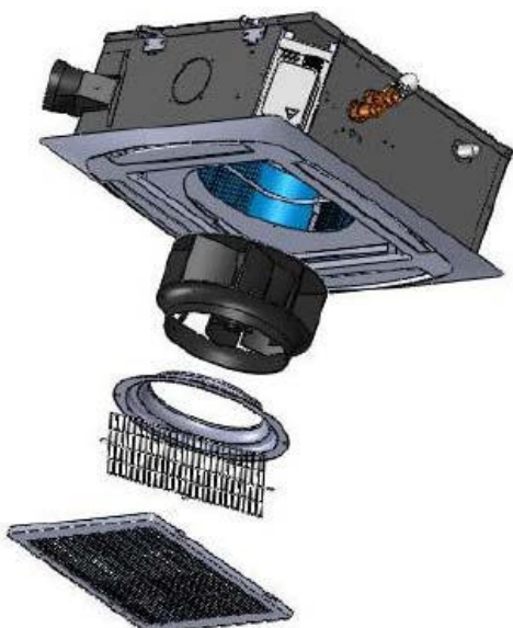
Obrázek 40 Krok 4: Pomocí klíče vyjměte ventilátor.
