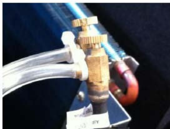
Obrázek 33 Krok 2: Otočením knoflíků uvolníte odvzdušňovací otvor / otvor k čištění vody.
